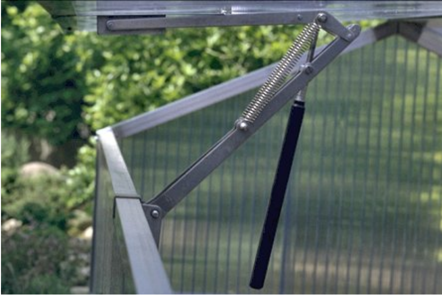
Automatischer Lüfter, betrieben durch ein sich bei zunehmender Wärme ausdehnendes Öl im Druckzylinder.
